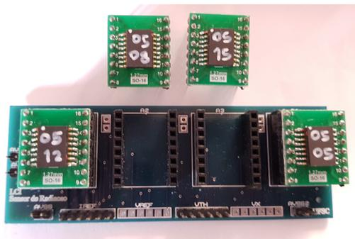
Figura 23 – Placa de circuito impresso desenvolvida para testar o circuito da primeira rodada do PMUB
