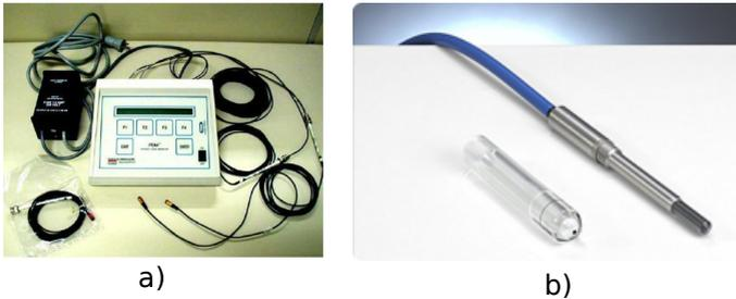
Figura 2 – a)Eletrômetro b)Diodo utilizado como dosímetro
