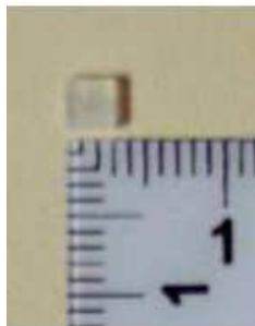
Figura 2.1: Foto de uma pastilha de um dosímetro termoluminescente (LiF:Mg, Ti, TLD-100) que possui dimensões de 3,2 mm x 3,2 mm x 0,9 mm (Figura adaptada de [3]).
