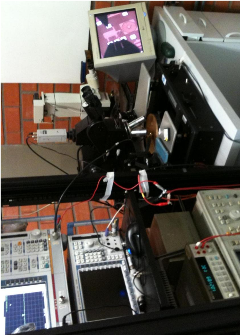
Figura 42 – Aparato de medição do conversor AC/DC integrado.
